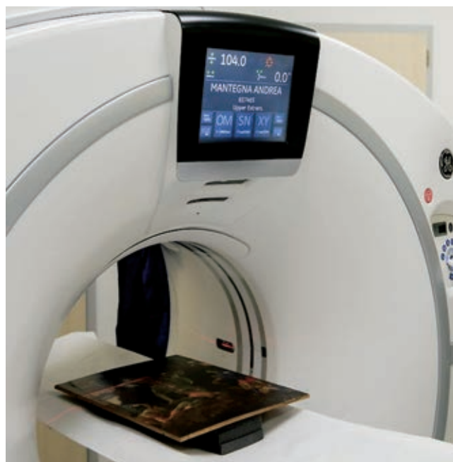
Фото. Момент сканирования картины «Воскресение Христа». Revolution CT (GE Healthcare). Диагностика позволила выявить детали, невидимые человеческому глазу.
